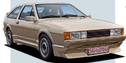
**ANTRIEB** R4-Zylinder, vorn quer eingebaut; 2-Ventiler; eine obenliegende Nockenwelle, Zahnriemen; Gemischbildung: Bosch K-Jetronic; Bohrung x Hub: 81,0 x 86,4 mm; Hubraum: 1781 cm³; Verdichtung: 10,0; Leistung: 82 kW/112 PS bei 5800/min; maximales Drehmoment: 159 Nm bei 4000/min; Fünfgang-Getriebe; Vorderradantrieb
