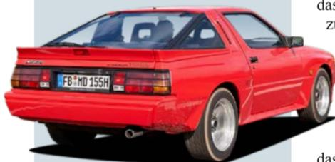
**ANTRIEB** R4-Zylinder, vorn längs eingebaut; 2-Ventiler; eine obenliegende Nockenwelle, Steuerkette; Gemischbildung: elektronische Einspritzung; Turbolader mit Ladeluftkühlung; Bohrung x Hub: 91,1 x 98,0 mm; Hubraum: 2555 cm<sup>3</sup>; Verdichtung: 7,0; Leistung: 114 kW/155 PS bei 5000/min; maximales Drehmoment: 284 Nm bei 2500/min; Fünfgang-Getriebe; Hinterradantrieb
