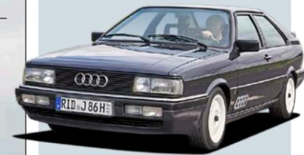
**ANTRIEB** R5-Zylinder, vorn längs eingebaut; 2-Ventiler; eine obenliegende Nockenwelle, Zahnriemenantrieb; Gemischbildung: Bosch KE-Jetronic; Bohrung x Hub: 81,0 x 86,4 mm; Hubraum: 2226 cm<sup>3</sup>; Verdichtung: 8,5; Leistung: 85 kW/115 PS bei 5500/min; maximales Drehmoment: 165 Nm bei 2500/min; Fünfgang-Getriebe; Vorderradantrieb
