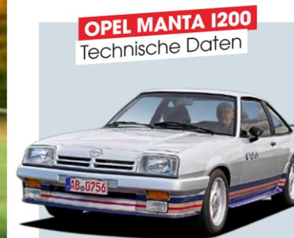
**ANTRIEB** R4-Zylinder, vorn längs eingebaut; 2-Ventiler; eine obenliegende Nockenwelle, Duplex-Rollenkette; Gemischbildung: Bosch LE-Jetronic; Bohrung x Hub: 95,0 x 69,8 mm; Hubraum: 1997 cm<sup>3</sup>; Verdichtung: 9,4; Leistung: 92 kW/125 PS bei 5900/min; maximales Drehmoment: 163 Nm bei 4700/min; Fünfgang-Getriebe; Hinterradantrieb
